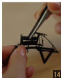
14 フレームにシートを取り付けます。
